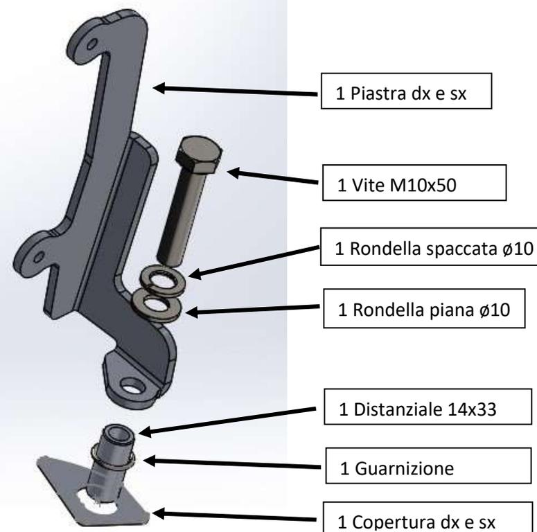
La sequenza di montaggio per il fissaggio della piastra sx è il medesimo
